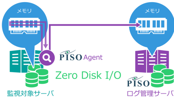
図 3: PISO メモリ参照技術の仕組み
